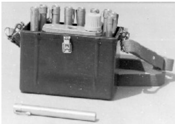
Комплект индивидуальных дозиметров предназначен для измерения поглощенных доз гамма-нейтронного излучения в интервале температур от минус 50 до плюс 50 $^\circ$ С, при изменении относительной влажности воздуха до 98%.
