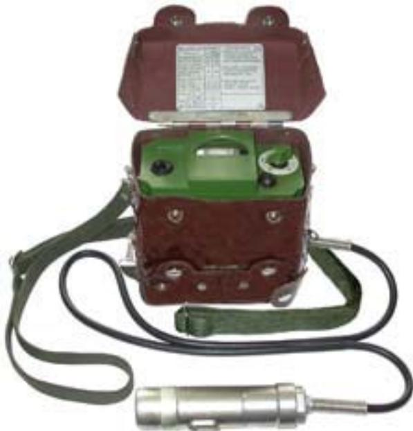
Измеритель мощности дозы (рентгенметр) ДП-5В предназначен для измерения уровней гамма-радиации и радиоактивной зараженности различных предметов по гамма-излучению.
